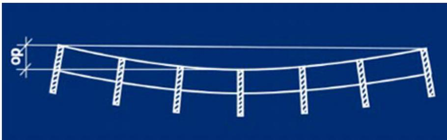
Abweichung für konkav  $o_q$  max. =  $1/200$  der Breite bei Abmessungen  $> 600$  mm;
